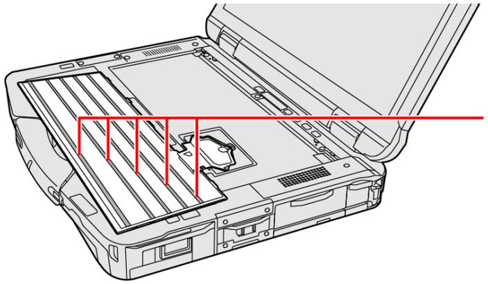
9. Führen Sie die Projektionsteile (J) der Tastatur in die (K)-Teile und befestigen Sie sie beim Absenken.
