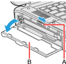
4. Setzen Sie eine Option an den linken Expansionsbereich.
