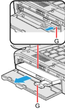
3. Setzen Sie eine Option ein, bis sie fest im Anschluss sitzt.
