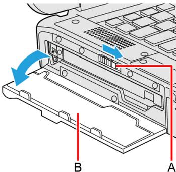
4. Setzen Sie eine Option an den linken Expansionsbereich.
