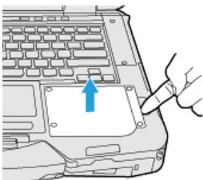
3. Setzen Sie eine Option ein, bis sie fest im Anschluss sitzt.
