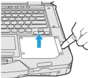
3. Insérez une option jusqu'à ce qu'elle s'emboîte dans le connecteur.
