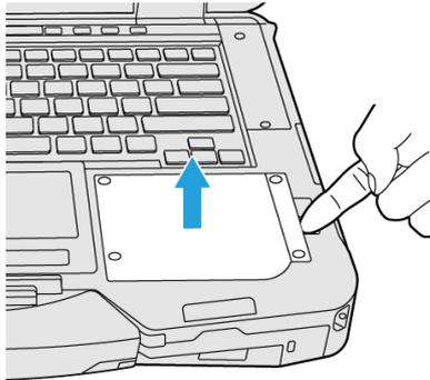
3. Inserire un'opzione fino a che non si inserisce correttamente nel connettore.
