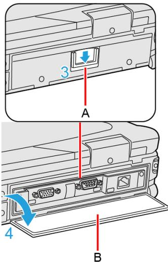
5. Inserire di un'opzione nell'area espansione posteriore.
