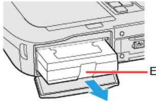
3. Insérez une option jusqu'à ce qu'elle s'emboîte dans le connecteur.
