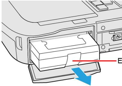
3. Setzen Sie eine Option ein, bis sie fest im Anschluss sitzt.
