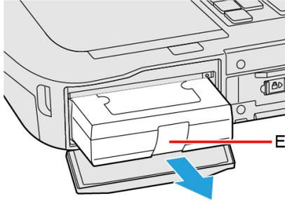
3. Inserire un'opzione fino a che non si inserisce correttamente nel connettore.
