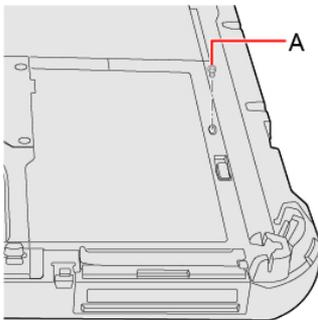
2. Wenn der Dummy-Pack eingesetzt wurde, entfernen Sie es.
